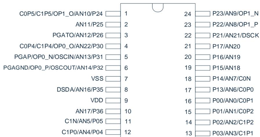
**3.1.6 CMS8S6990-QFN24 Pin diagram**
